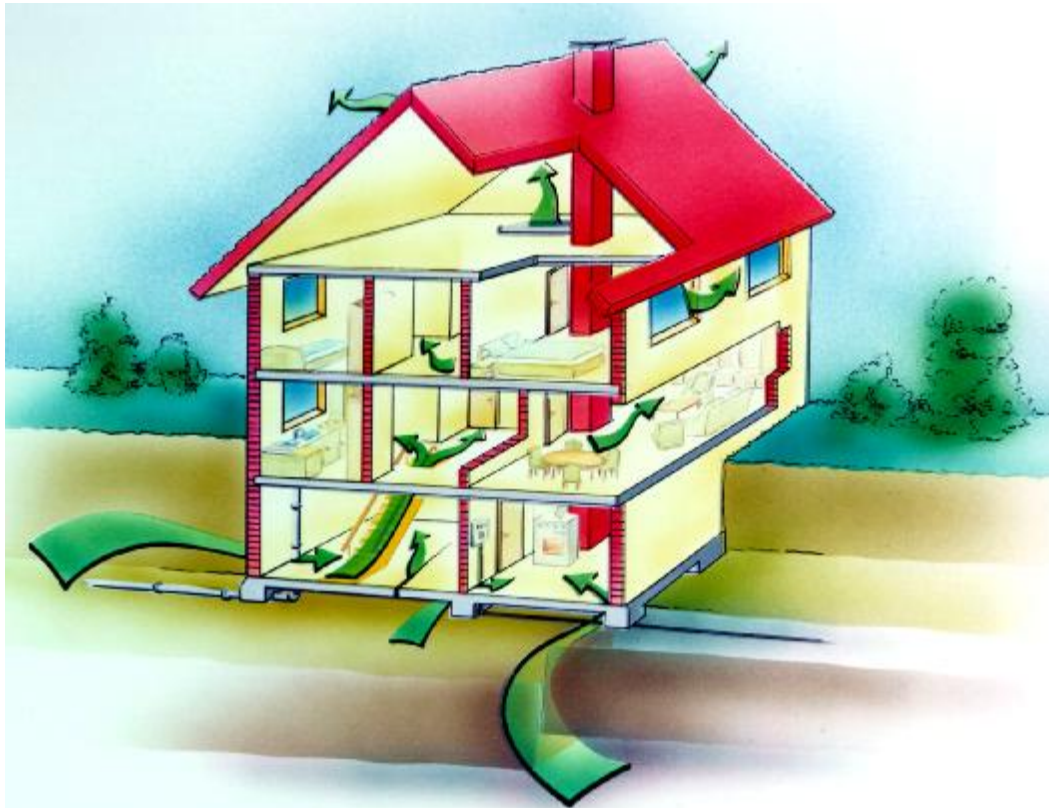
Verteilung von Radon in einem Haus (Grafik: GSF).
